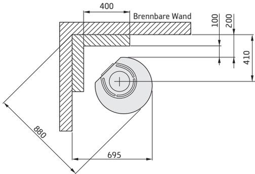
Für brennbare Baubestandteile zugelassener Bereich
