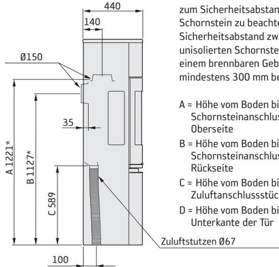
Der Mindestabstand zwischen Kaminofenöffnung und einem brennbaren Gebäudeteil oder Einrichtungsgegenständen beträgt 1 m.
