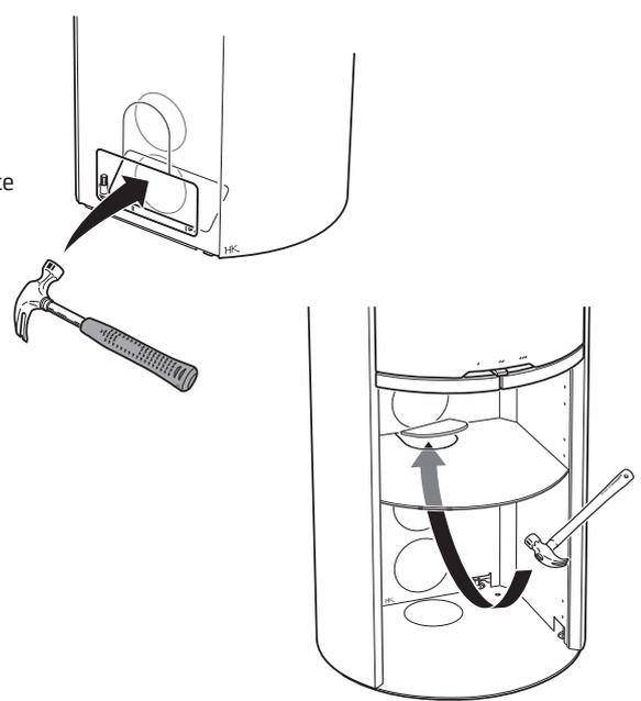
Ein Außenluftanschluss ist durch die Bodenplatte oder auf zwei verschiedenen Höhen durch die doppelten Bleche an der Kaminofenrückseite möglich. Schlagen Sie die Sollbruchstelle mit einem Hammer heraus.
